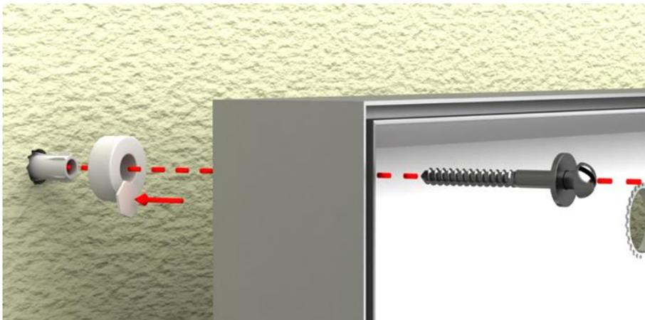
Die Leitungen können dann zwischen Wand und Gerät zugeführt werden (Aufputzverlegung). Benutzen Sie zur Fixierung der Distanzscheiben während der Montage die mitgelieferten sechseckigen Selbstklebepunkte.
