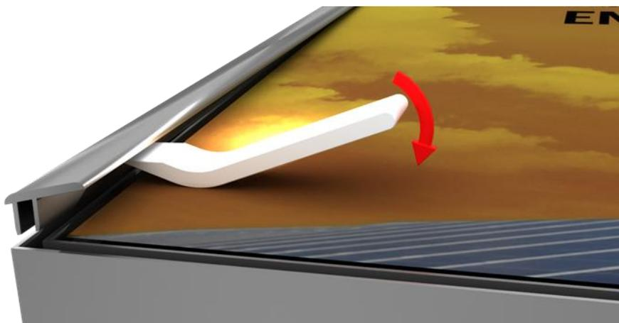
Öffnen Sie das Gerät, indem Sie mit dem Hebelwerkzeug zunächst die Steckleisten und anschließend die Frontscheibe entfernen.
